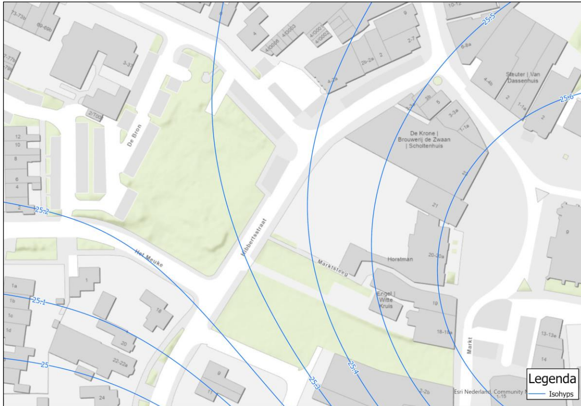
Afbeelding 4: Isohypskaart GHG op basis van grondwatermeetgegevens peilbuizen
