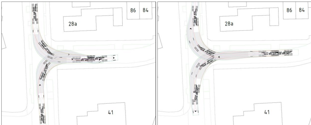
Figuur 2.9 Rijcurven kruispunt Lansinkstraat – Het Meuke trekker met oplegger ingaand (links) en uitgaand (rechts)
